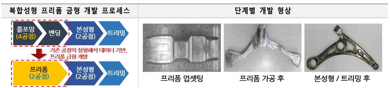
[그림 9] 동사의 알루미늄 단조 로어암 개발 프로세스 및 개발 형상
