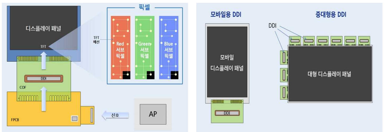
[그림 4] 디스플레이 구동 신호 흐름도(왼쪽) 및 DDI 종류(오른쪽)
