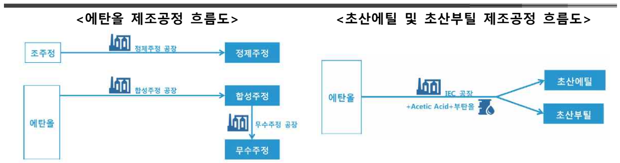
그림 7. 동사의 에탄올 제조공정과 초산에틸 및 초산부틸 제조공정
