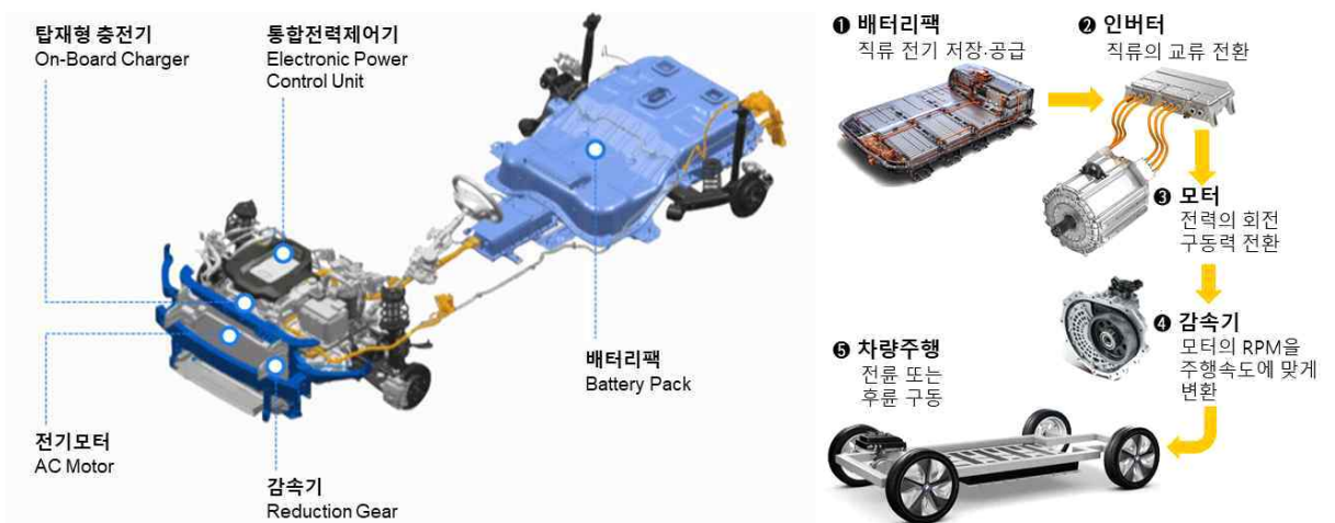
[그림 15] 전기자동차 파워트레인 및 구동원리
