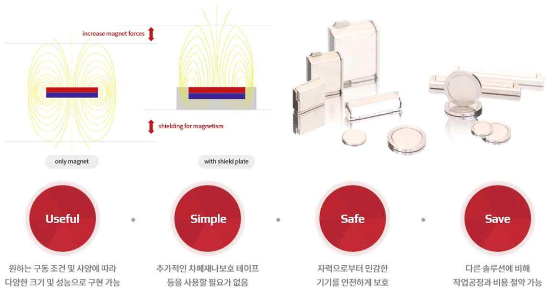
그림 7. 차폐자석의 원리와 동사 차폐자석 주요 특징
