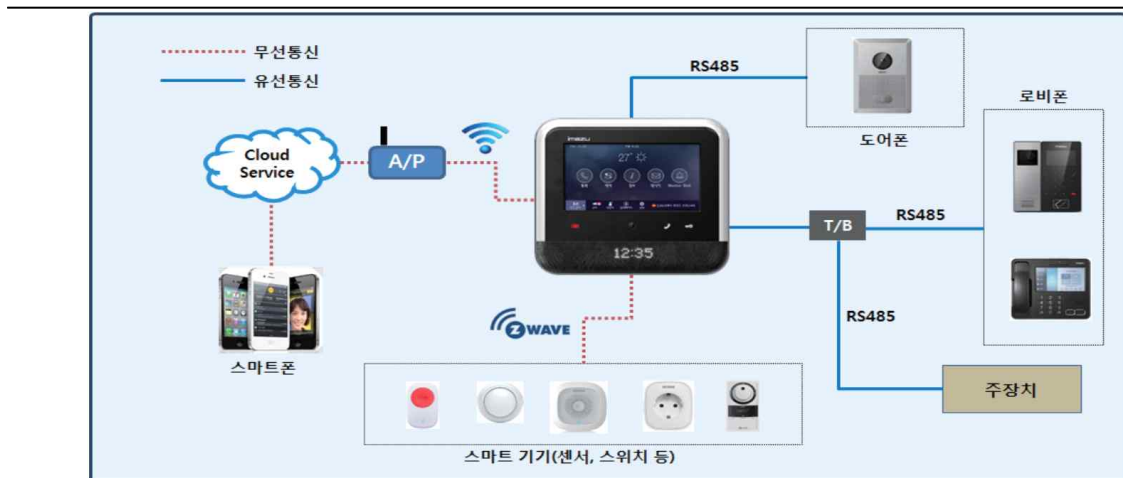
[그림 5] 월패드를 중심으로 구성된 스마트홈 시스템 구성도
