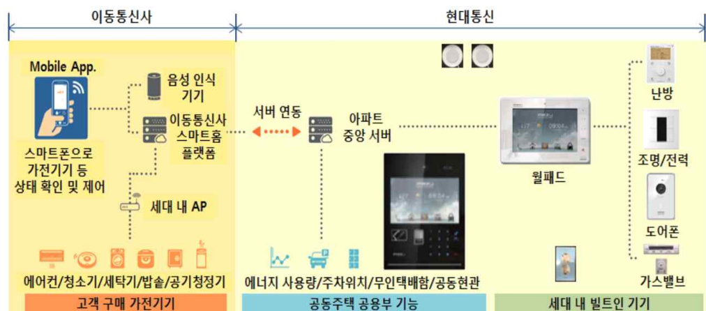
[그림 7] 통신사업자의 IoT 플랫폼과 연결되는 홈네트워크 예시
