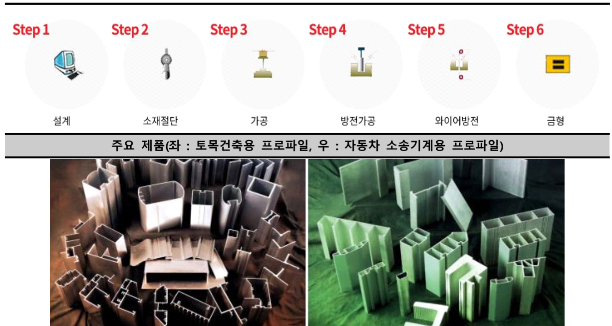
[그림 9] 금형 제조 공정 Process 및 주요 제품
