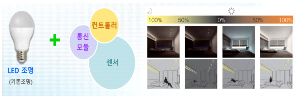
[그림 5] 스마트조명의 구성도 및 조명제어시스템 적용 예시
