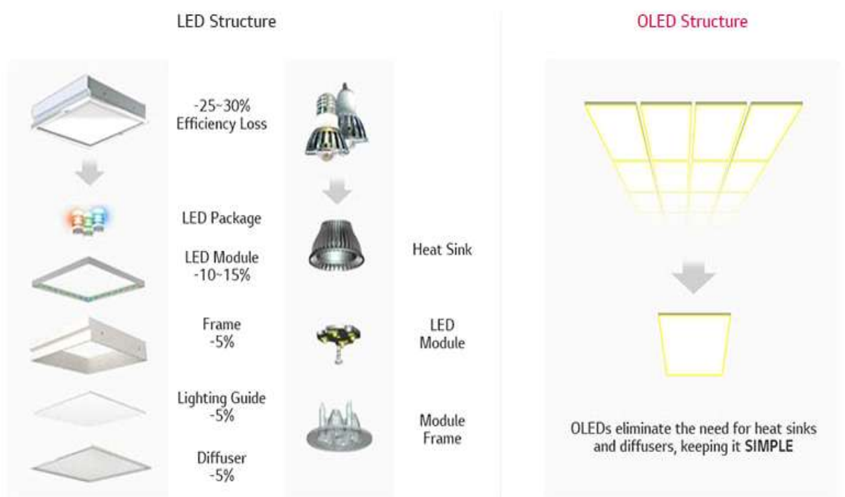
[그림 2] LED조명 VS OLED조명의 구조
