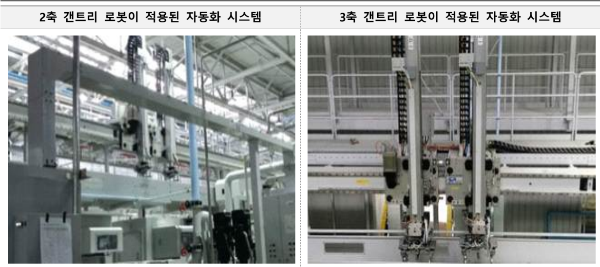
[그림 6] 2축, 3축 갠트리 로봇이 적용된 동사의 자동화 시스템
