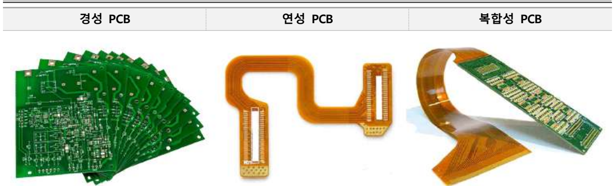
[그림 7] 재질 및 굴곡성에 따른 PCB 분류
