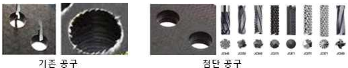
그림 7. 기존 공구와 첨단 공구의 CFRP 가공 차이
