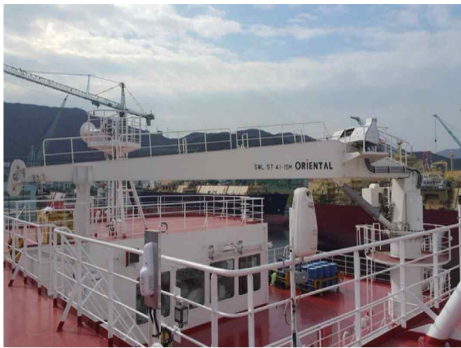
[그림 21] 극저온 작동 Jib Crane
