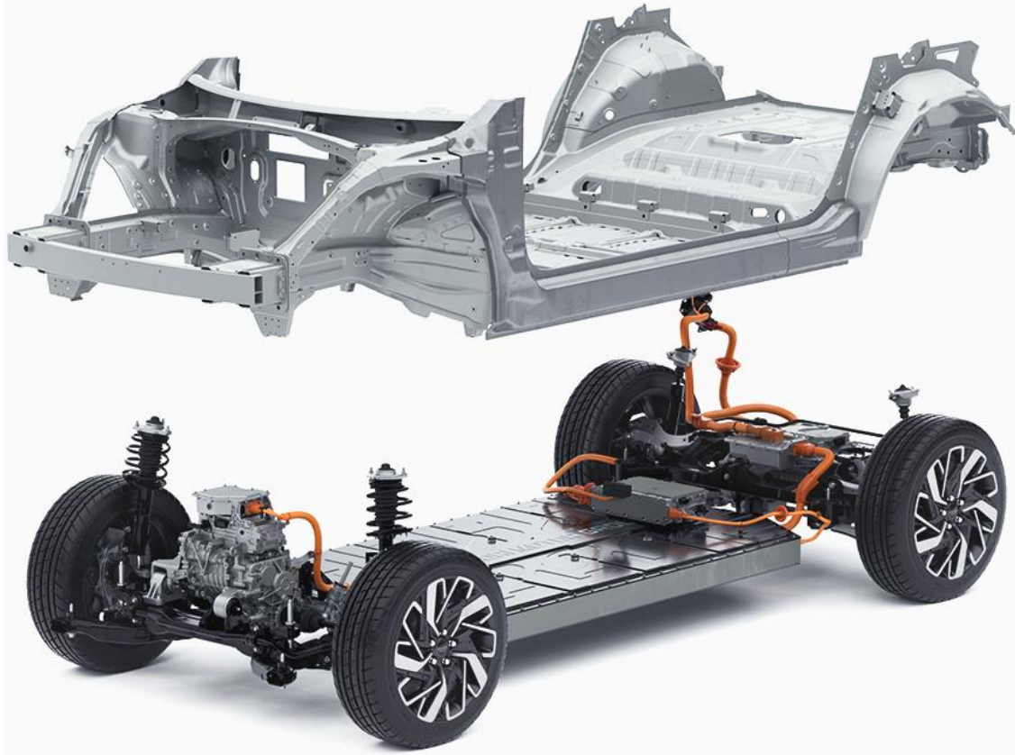
그림 9. 현대차그룹의 E-GMP 구조
