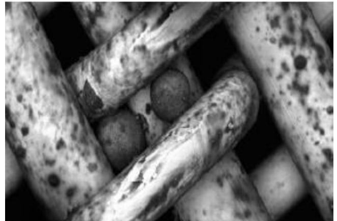
그림 3. Cat fines entrapped in the mesh of a fuel filter
