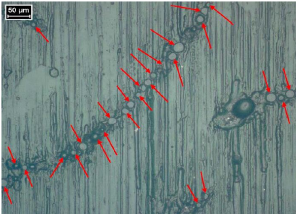
그림 2. Red arrows show cat fines embedded in cylinder liner
