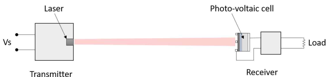
[그림 12] 이스라엘 Wi-Charge의 무선전력 송수신 원리
