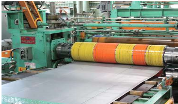
[그림 16] SLITTING 장비 및 분단 가공 도식도
