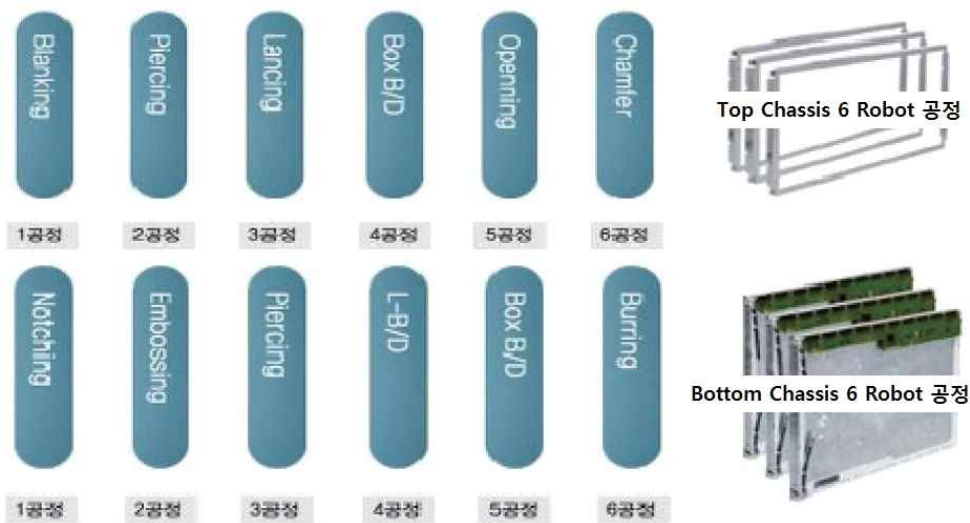
[그림 9] 인지디스플레이 Top & Bottom Chassis 6 Robot 공정
