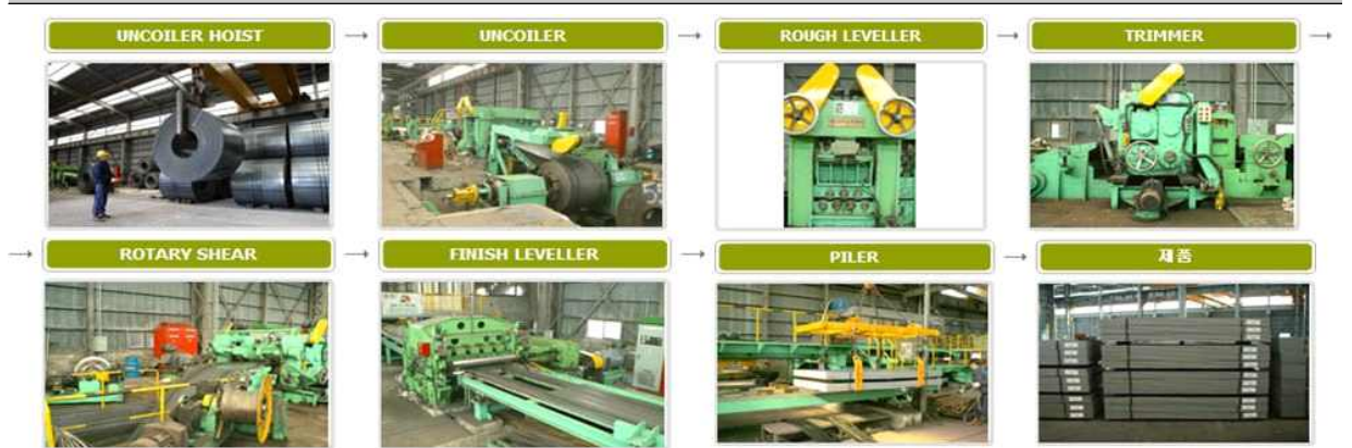
[그림 10] 열연강판 Shearing 공정도
