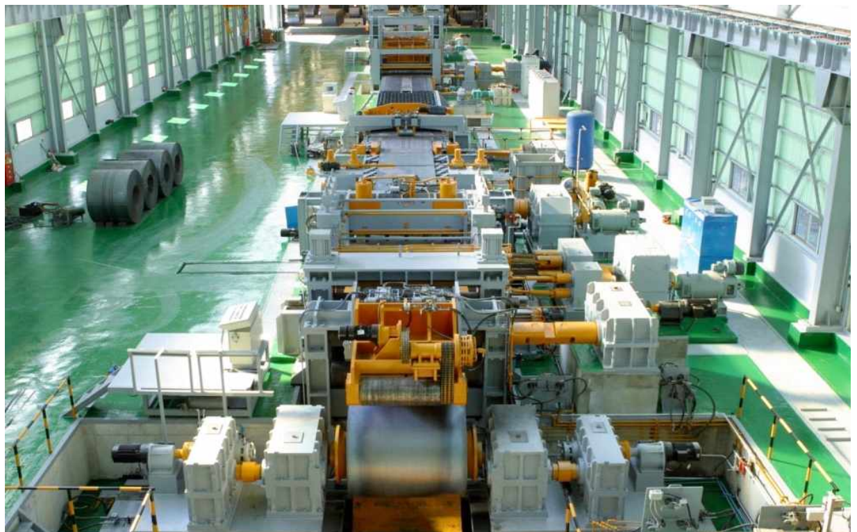
[그림 20] 포항 제2공장 25mm Shearing Line
