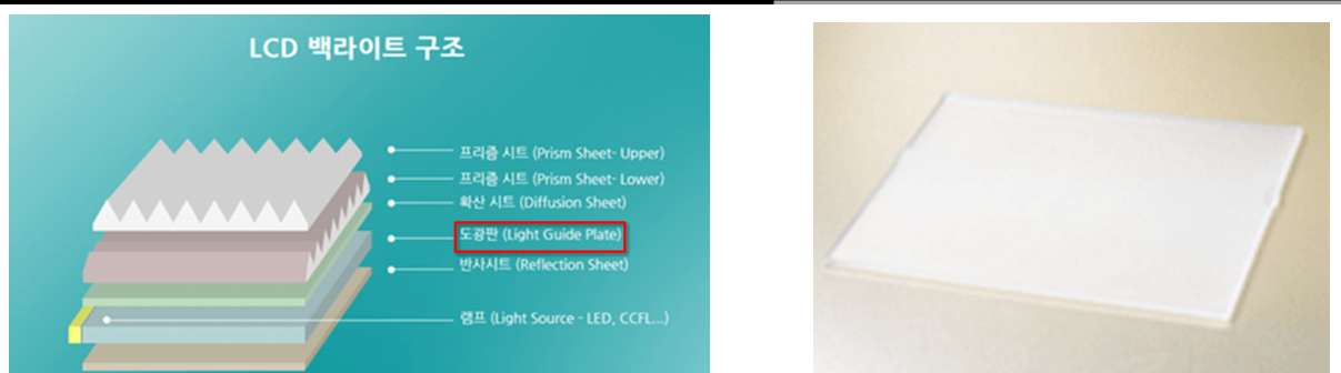
그림 18. LCD BLU 구조(좌) 및 도광판(우)
