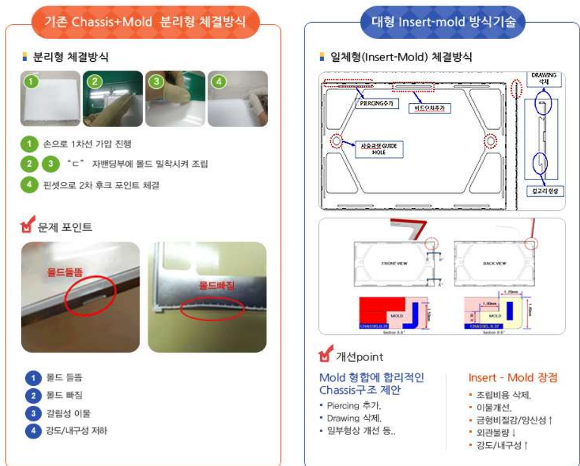
[그림 9] 대형 Insert-mold 방식
