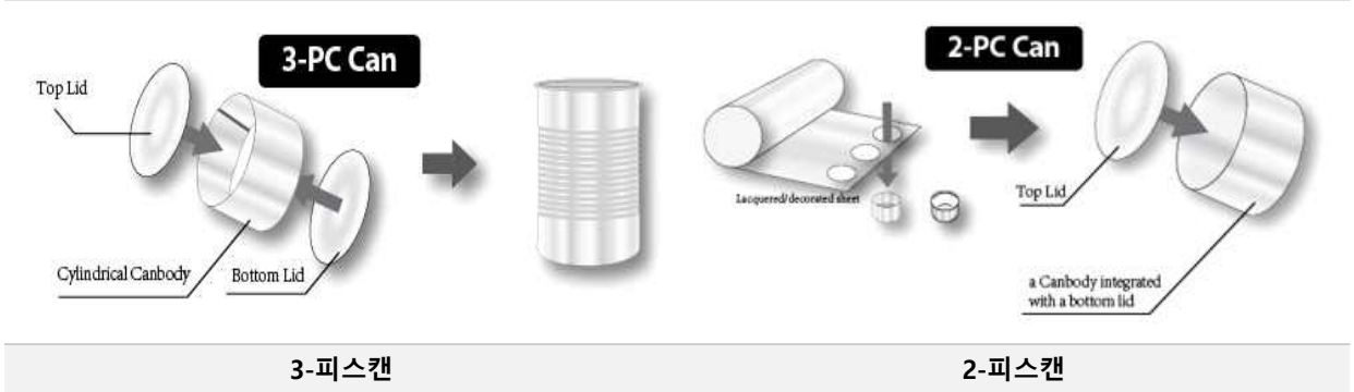
[그림 8] 금속 포장용기의 부품 구성에 따른 분류(3-피스캔, 2-피스캔)
