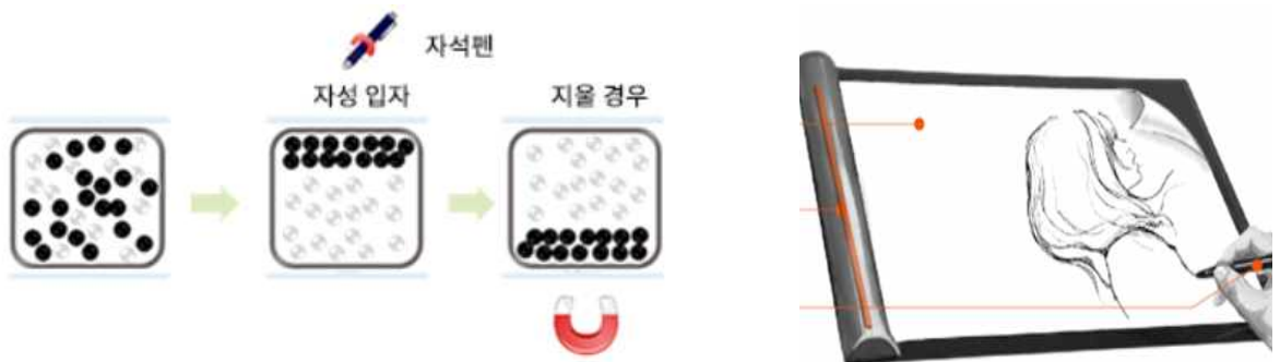
그림 13. 자기영동소재 원리 및 적용
