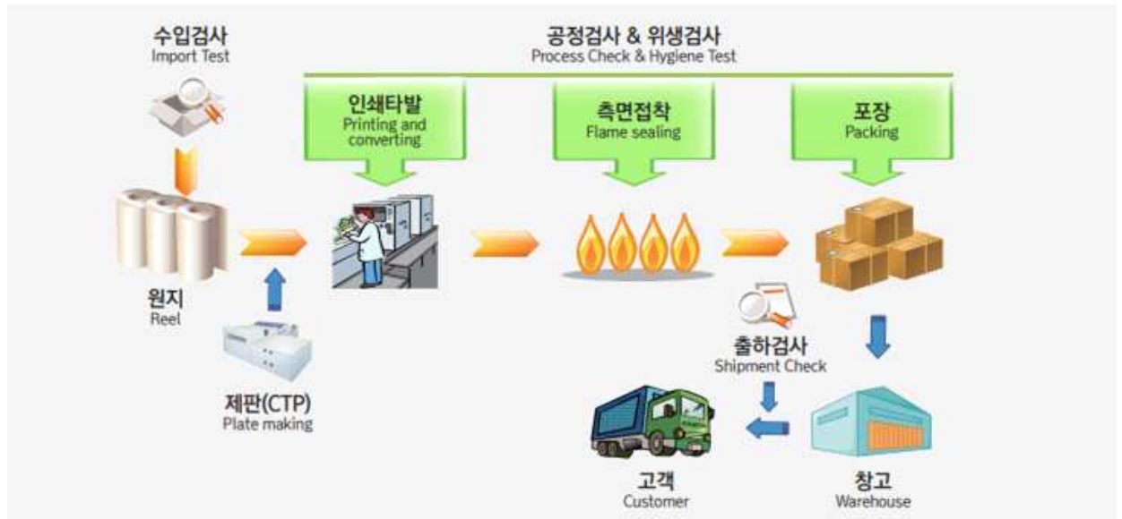
[그림 5] 동사 카톤팩 제조공정의 전체 모식도
