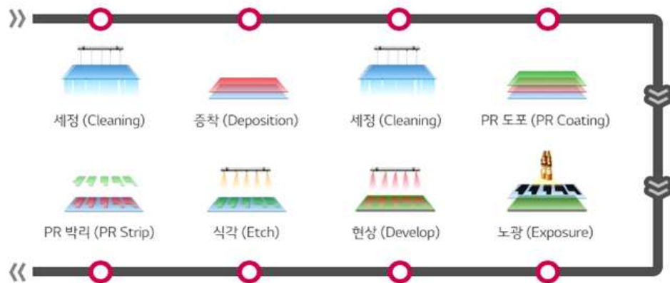
그림 5. 디스플레이 패널 제조 공정도
