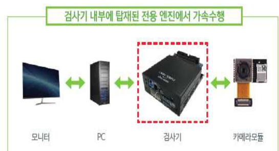
[그림 7] 동사 카메라 모듈 검사 솔루션 인터페이스 속도 및 검사 알고리즘 수행 방식
