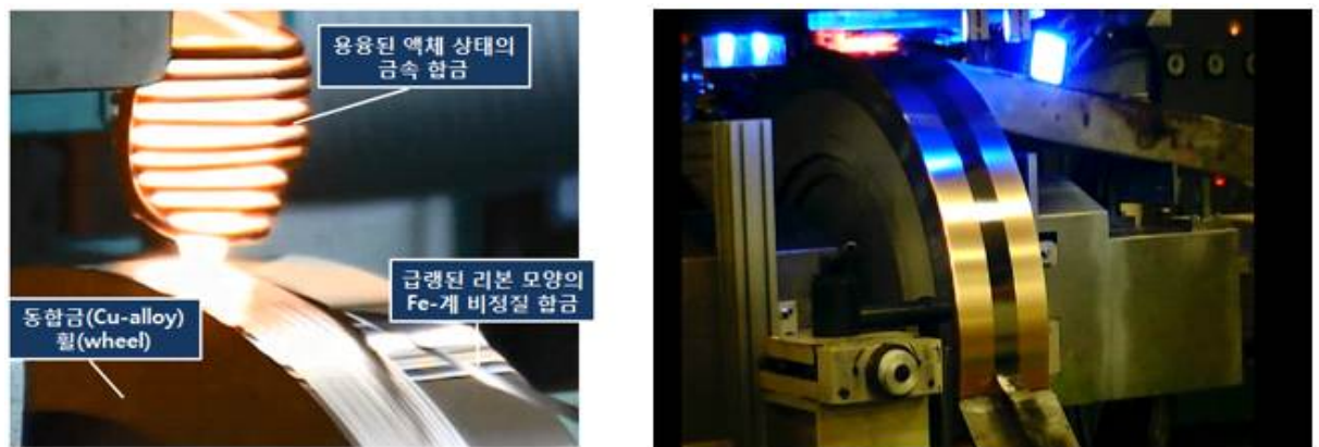
그림 5. 연구용 소형 급속 응고장치(좌) 및 대량 생산용 대형 급속 응고장치(우)
