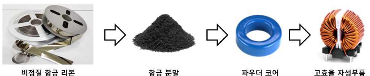
그림 6. 분말화 공정을 통한 고효율 자성부품 생산 개략도
