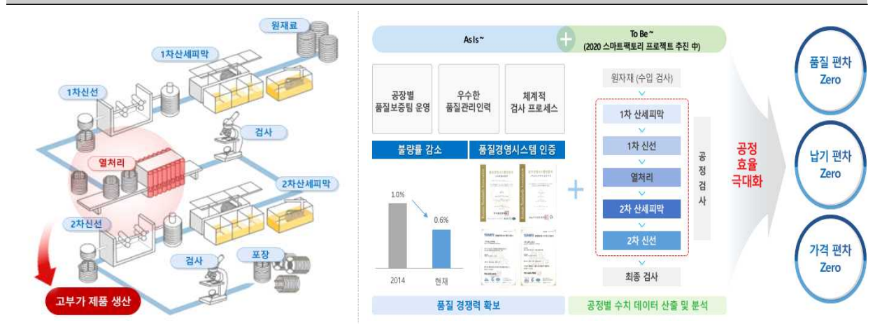
[그림 9] 냉간압조용 강선 제조공정(좌), 품질관리 현황 및 향후 계획(우)
