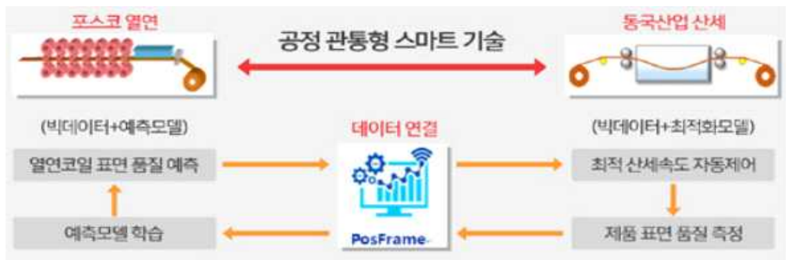
[그림 7] AI 산세조업 제어 시스템
