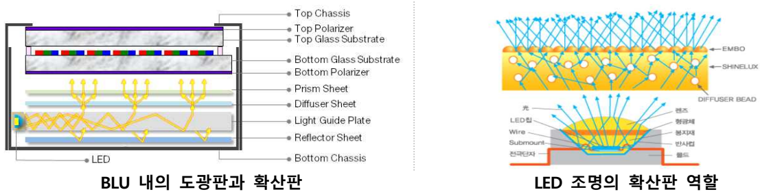
그림 4. 도광판과 확산판 원리 및 구조
