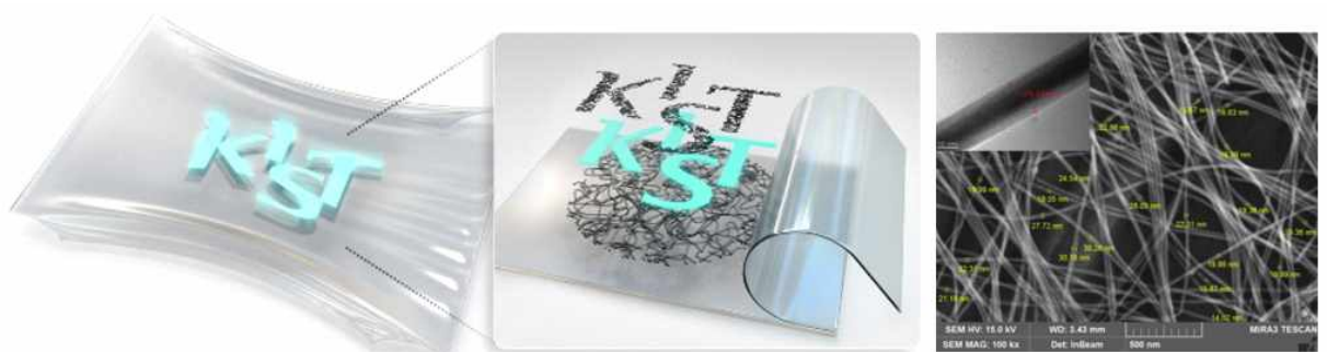
[그림 4] 은 나노와이어 투명전도성필름(좌) 및 SEM/TEM 이미지(우)
