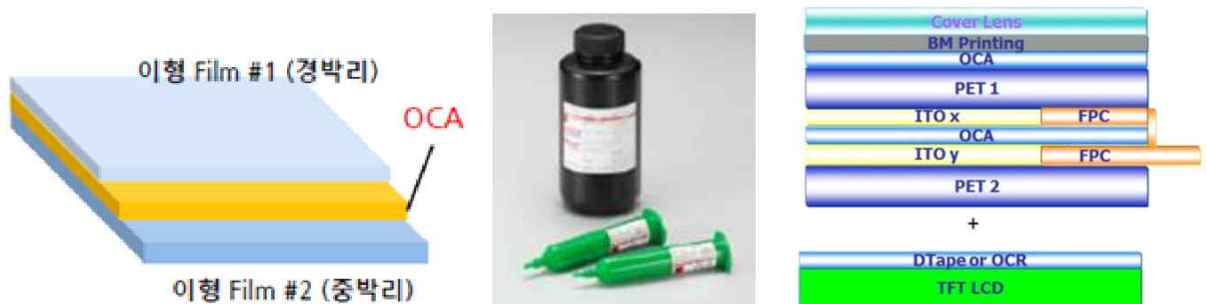
[그림 8] OCA 필름 구조(좌), OCR 판매 형태(중), OCA/OCR 적용 사례(우)
