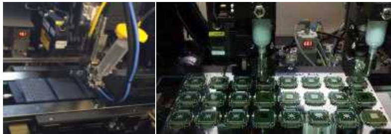
그림 15. 압전소자를 피에조 젯 밸브, 듀얼 헤드 적용 예시
