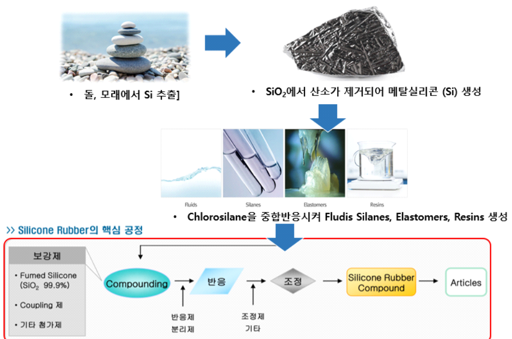
그림 11. 실리콘 고무 제조 공정
