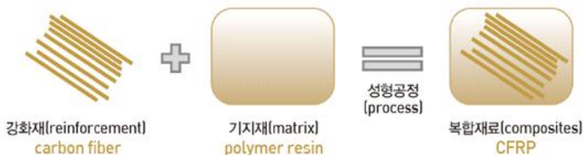
[그림 4] 탄소섬유강화플라스틱(CFRP)의 개념도
