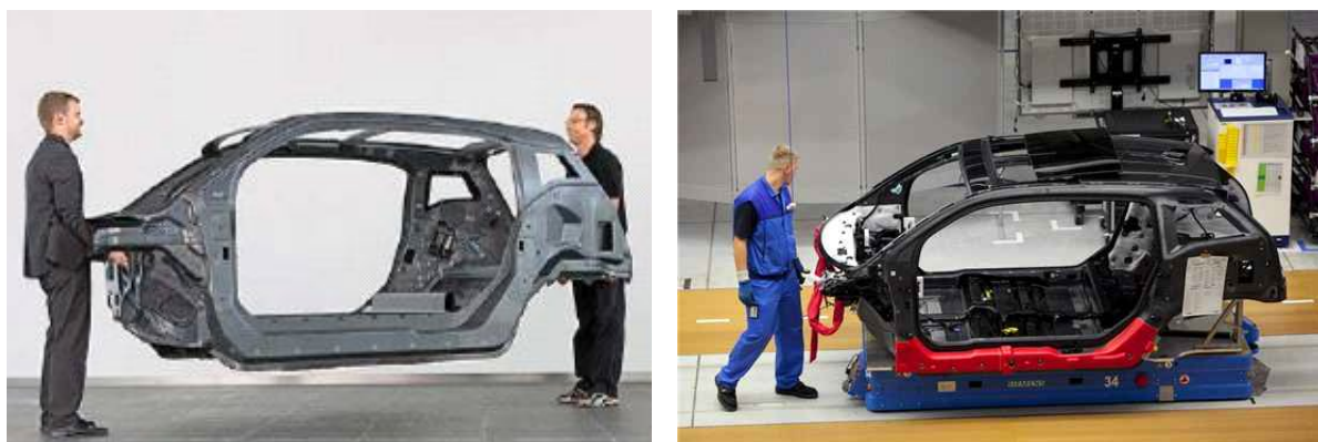
[그림 10] BMW i3에 적용된 CFRP 차체
