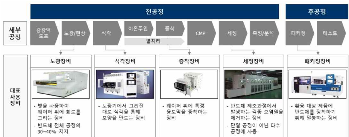
그림 08. 반도체 공정별 대표 사용 장비
