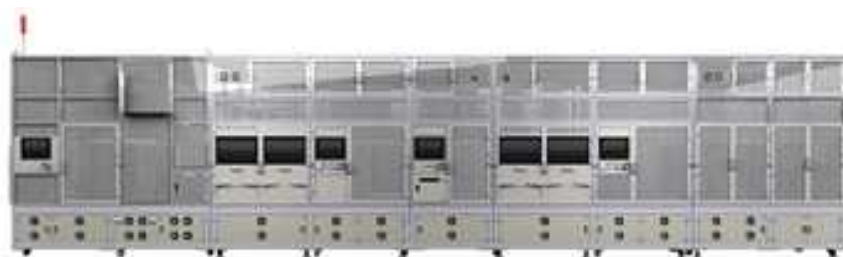
[그림 13] 2차전지 Cell 외관 검사 장비
