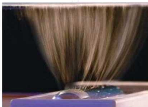
[그림 6] 전기방사 대량 생산을 위한 Needleless 전기방사 공정
