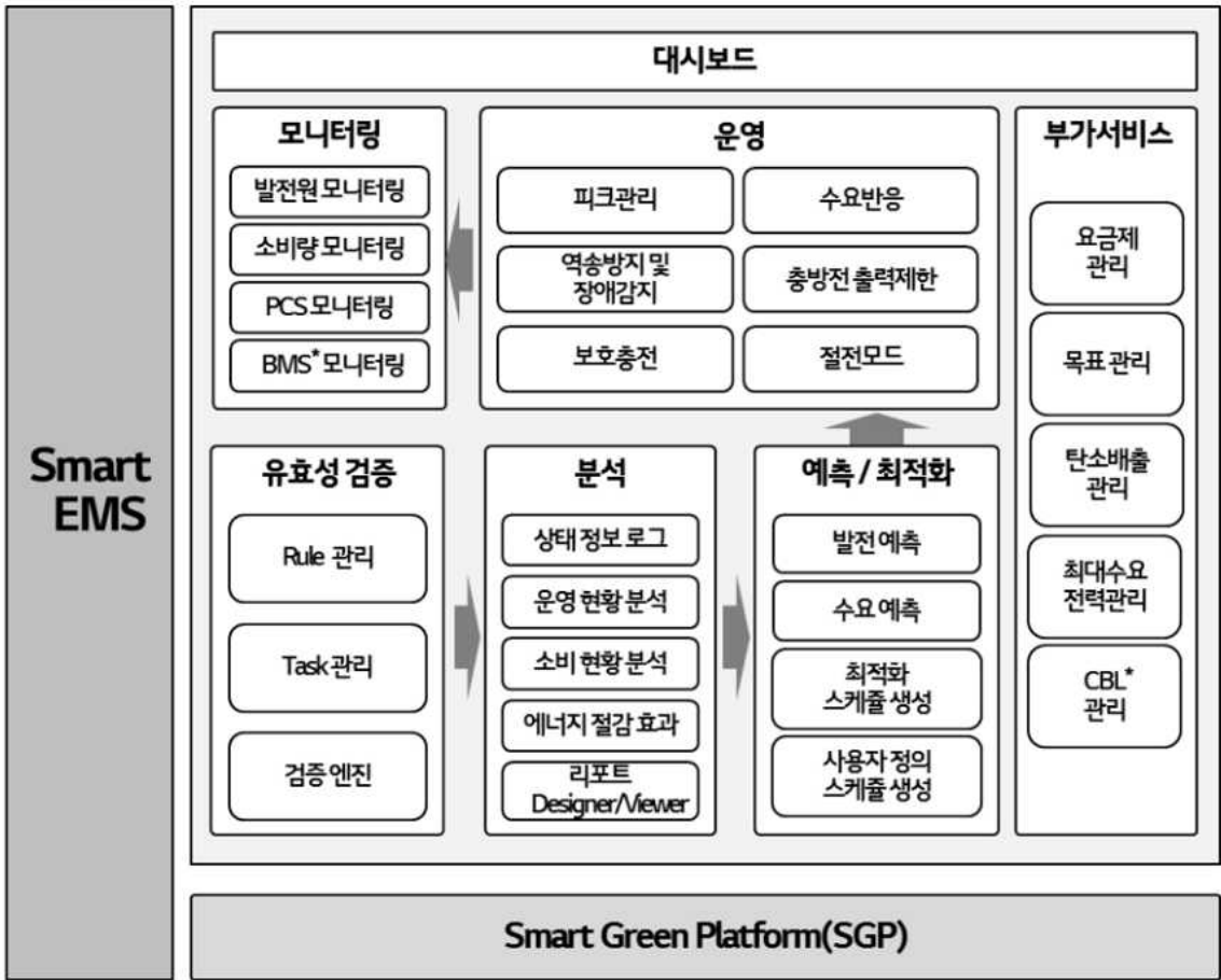
[그림9] EMS 구성 사례 (LG CNS의 Smart EMS 구성)
