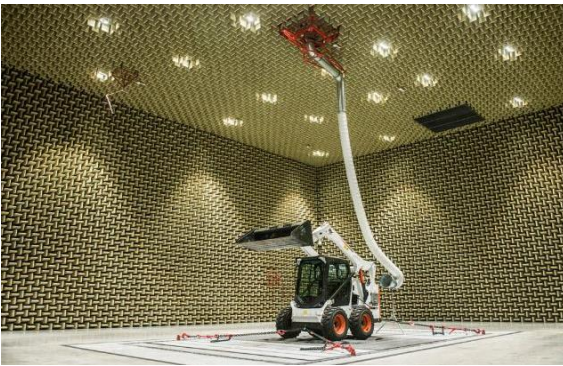
도표 12. Innovation 센터 내 소음 측정 테스트 설비
