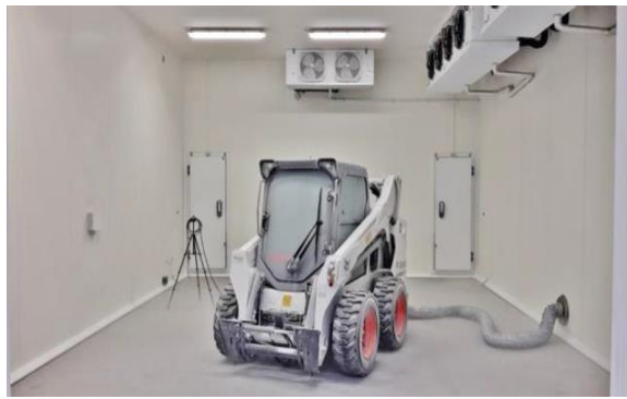
도표 13. Innovation 센터 내 혹한기 테스트 설비
