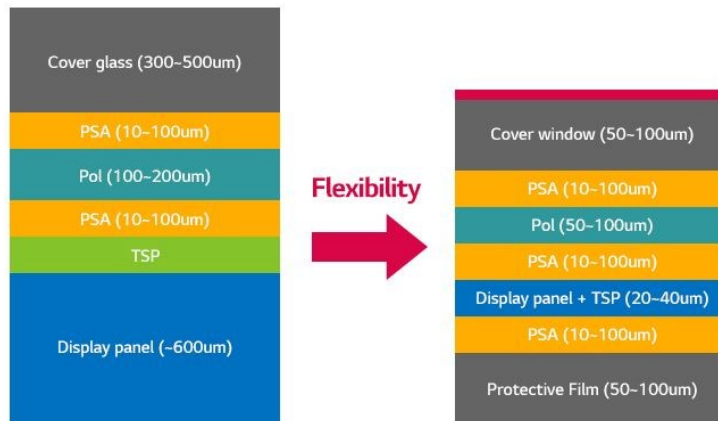
그림 3. OLED 패널 구조도 및 두께 (좌측이 Rigid OLED, 우측이 Flexible OLED)
