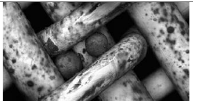
그림 7. 저황유의 불순물 Cat fines이 실린더 라이너 내부에 침착
