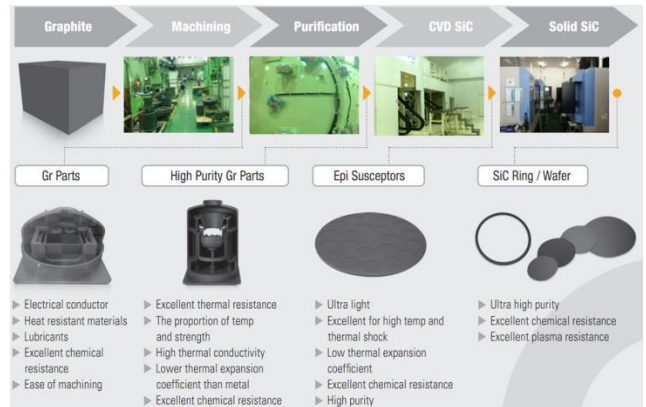
그림 8. 단계별 생산되는 제품. 링 소모품은 코팅, 가공 끝나야 완성
