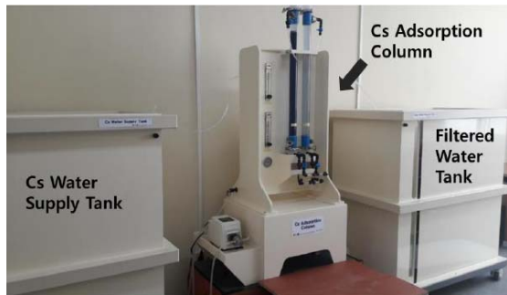
Cs 회수공정 Pilot 장치
