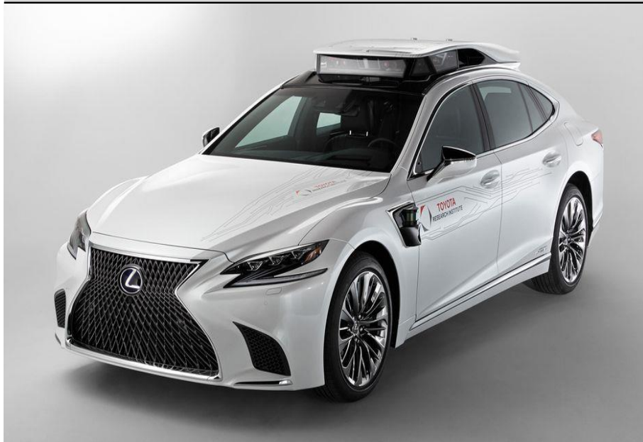
TRI-P4: 첨단 주행보조 시스템 탑재한 시험차량
