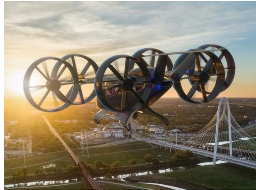
그림112. 6개의 덕트형 틸팅팬으로 비행중인 Nexus 모습
