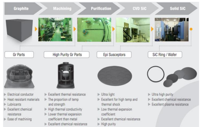
그림 2. 단계별 생산되는 제품. 링 소모품은 코팅, 가공 끝나야 완성
