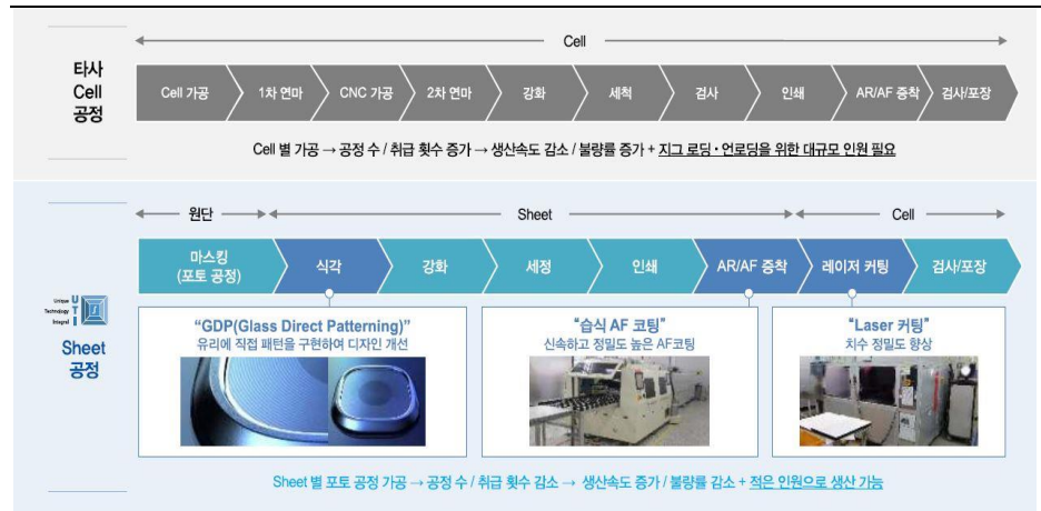
[그림 1] Sheet 단위 공정 vs 타사 Cell 단위 공정
