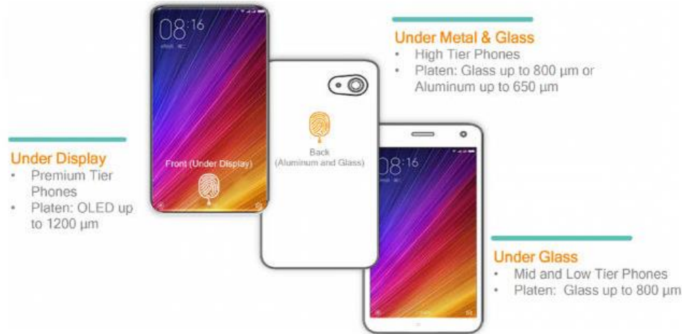
그림65. Qualcomm의 Sense ID는 OLED 패널 기준 1,200um 두께 투과 가능
