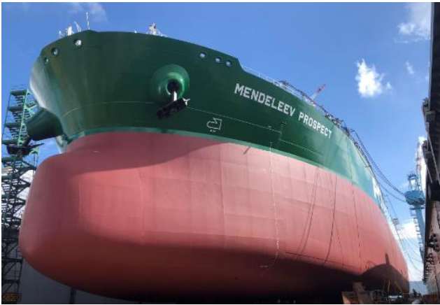
그림18. 현대삼호중공업의 플로팅_도크에서 건조 중인 SCF의 LNG-Fuel 탱커
