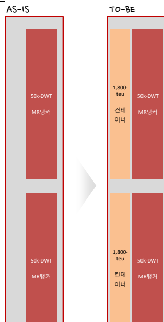
그림9. 3 분기부터 1~3 도크에 MR 탱커 2 척과 Feeder 선 동시 건조로, 건조량 증가와 생산성 제고로, 고정비 개선 효과 보일 것
